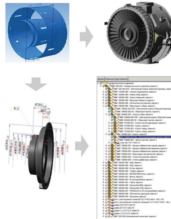
Рисунок 6 – Пример проектирования изделия в CAD программе
